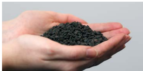
Getrockneter Klärschlamm ist geruchsneutral und hygienisch unbedenklich.
